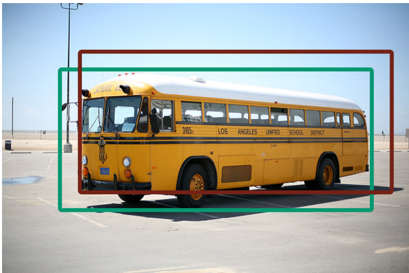
図 4.3 画像に対して IoU の計算方法. 緑のバウンディングボックスはラベル, 赤のバウンディングボックスは結果で表す.
