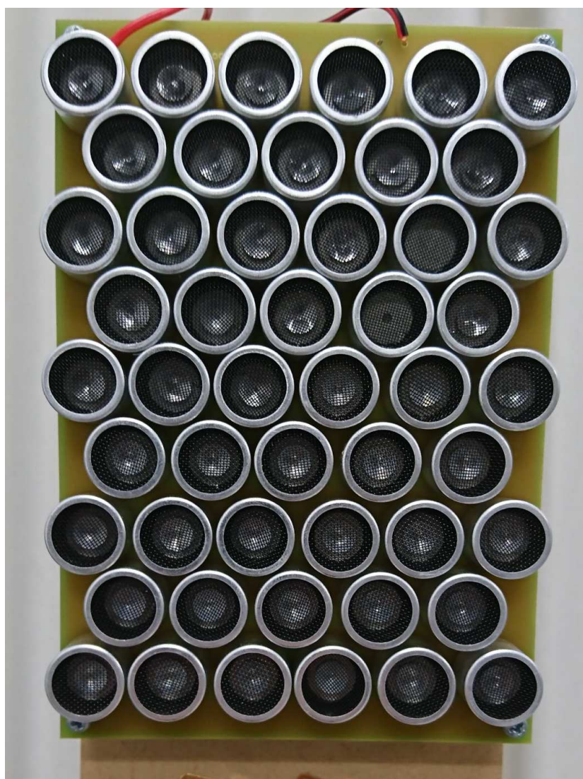
図 4.3 実験で使った超音波エミッタ
